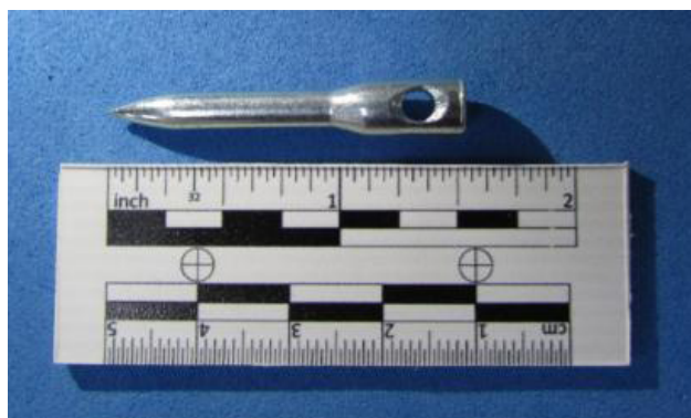
Figura 5: Pino metálico normalmente utilizado para fixação no concreto.
